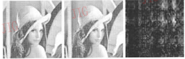
(a) Lena 原始图像 (b) 嵌入水印后的图像 (c) 绝对差图像
